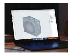
Diseña tu modelo con el software CAD que prefieras y después importa el archivo STL o OBJ a nuestro software de preparación de la impresión, PreForm.
